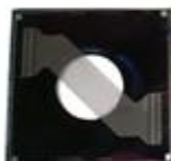
ММД: 64 стріпи, крок 100 мкм, ширина 40 мкм, товщина 1 мкм
